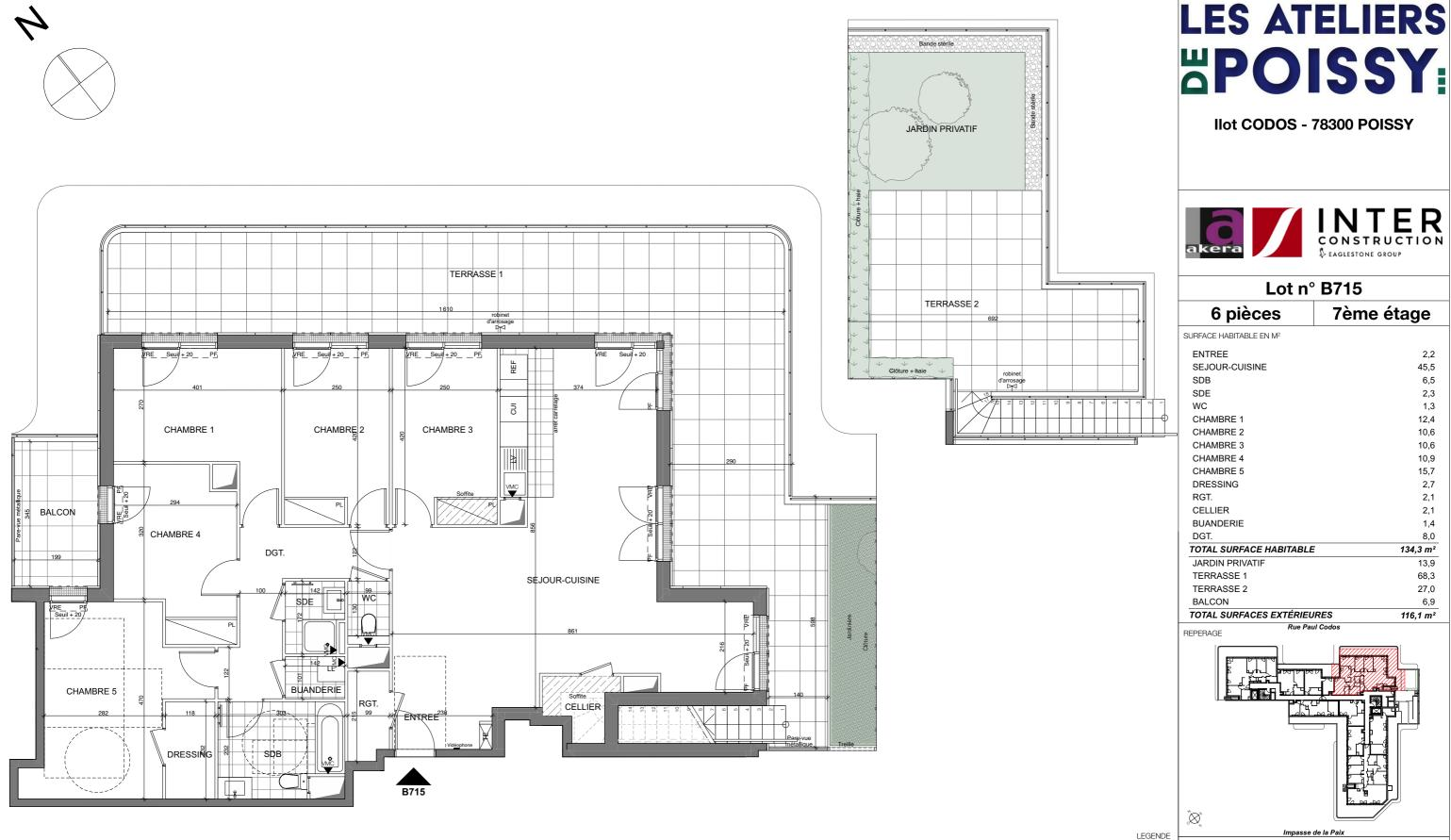
F : FENETRE PF : PORTE FENETRE VR : VOLET ROULANT PL : PLACARD TE : TABLEAU ELECTRIQUE JS : JOUR DE SOUFFRANCE LL : EMPLACEMENT LAVE-LINGE LV : EMPLACEMENT LAVE-VAISSELLE Ref: EMPLACEMENT REFRIGERATEUR Cui : EMPLACEMENT FOUR-CUISSON
